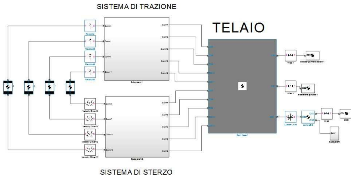
Figura 14 - Struttura ottimizzata del modello Simulink.
