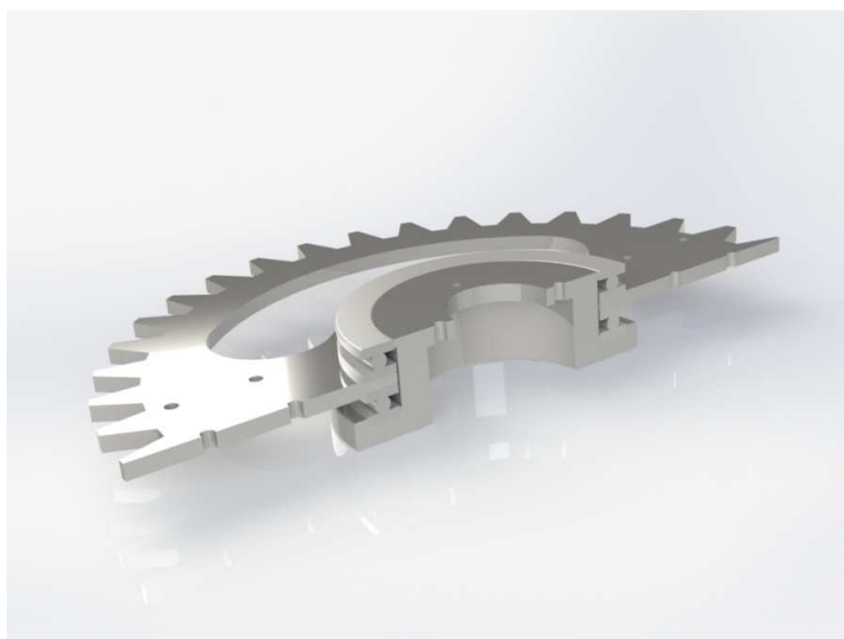
Figura 8 – Sezione supporto ruota dentata e cuscinetti
